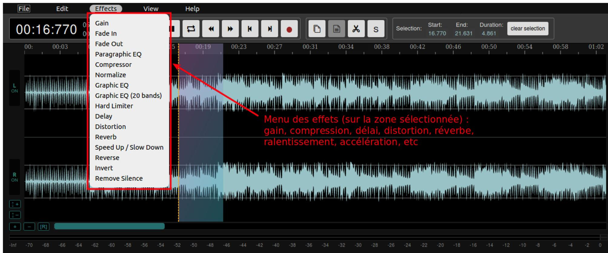
**Gain** : ajustement du niveau ou volume d'entrée
